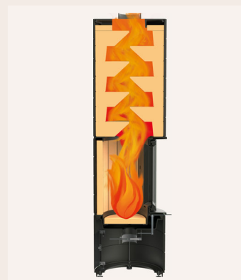
COLONA: Déviation des fumées via le cœur en chamotte Geleiding van de verwarmingsgassen door de chamottekern
